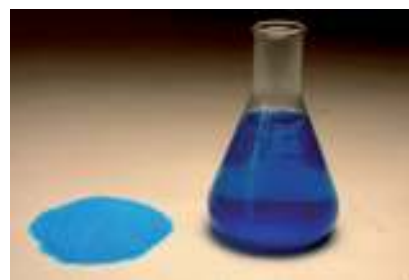
■ Sulfato cúprico hidratado
