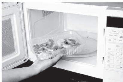
Las microondas son absorbidas por las moléculas de agua presente en los alimentos, lo que produce una agitación molecular que aumenta la temperatura.
